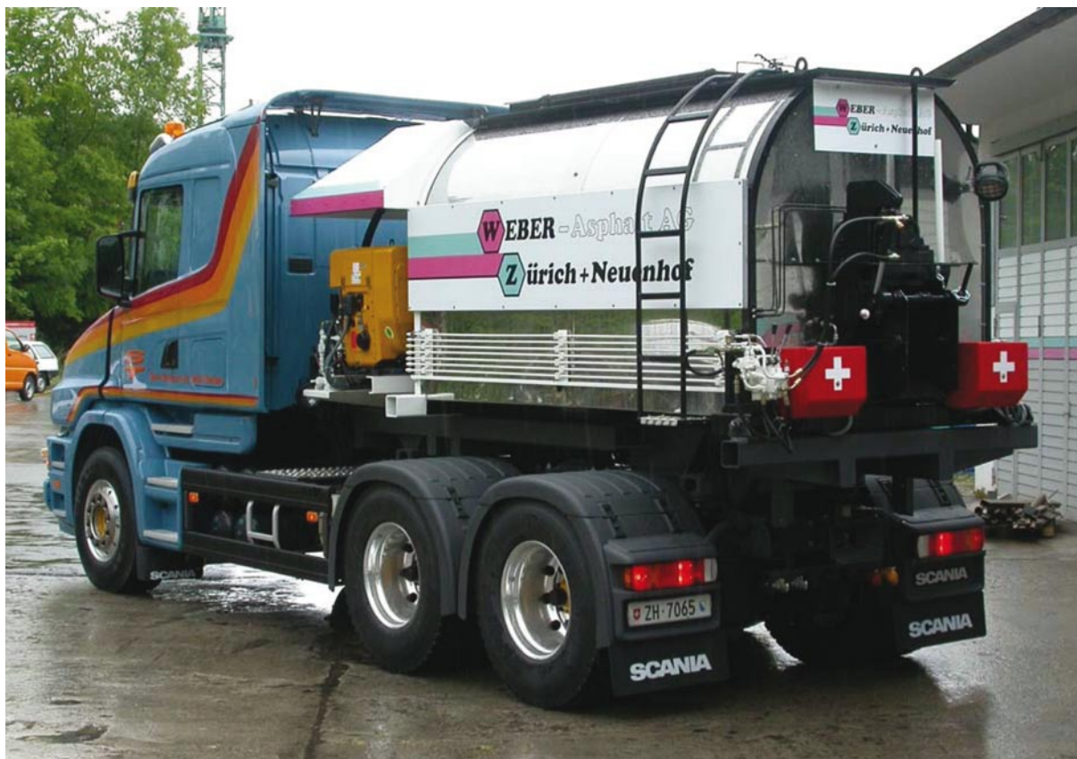
Bild 9. Transport av gjutasfaltblandare [The Mastic Asphalt Industry].
